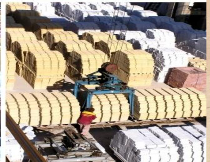
Продукция марки «Глубокинский кирпич» изготавливается из кварцевого песка (с высоким содержанием кварца – до 99%) и извести, поэтому она обладает исключительной прочностью и выдерживает нагрузки до 300 килограмм на квадратный сантиметр. В производстве используются светостойкие красители, содержащие окись железа, благодаря чему продукция со временем не теряет цвет.
