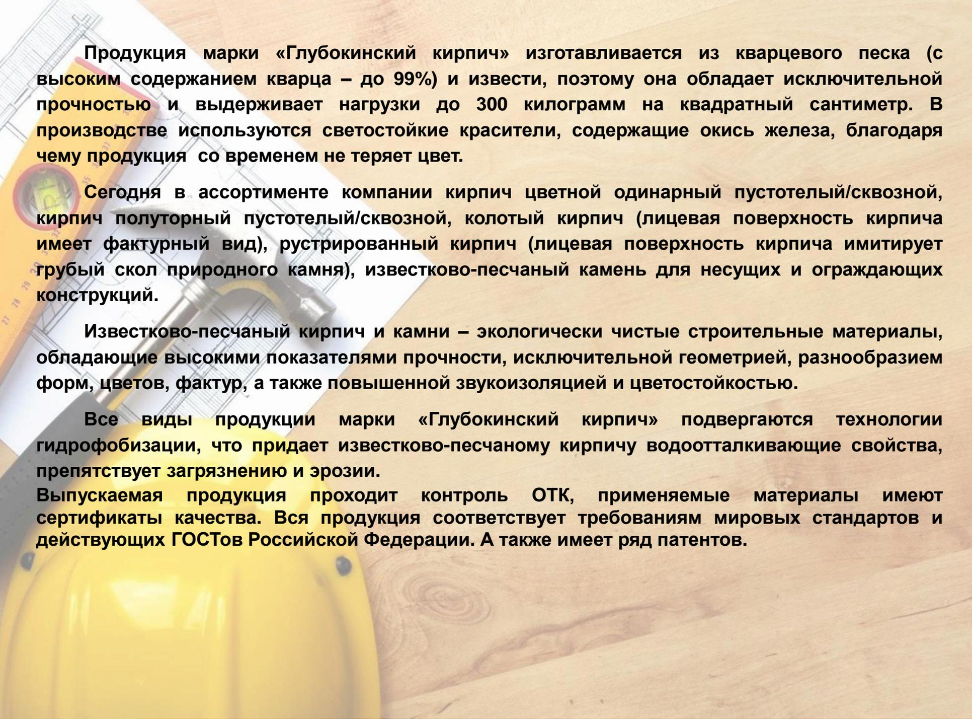
Продукция марки «Глубокинский кирпич» изготавливается из кварцевого песка (с высоким содержанием кварца – до 99%) и извести, поэтому она обладает исключительной прочностью и выдерживает нагрузки до 300 килограмм на квадратный сантиметр. В производстве используются светостойкие красители, содержащие окись железа, благодаря чему продукция со временем не теряет цвет.
